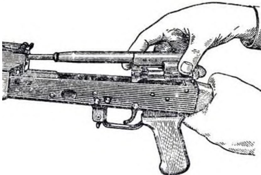
Рис. 26. Отделение затворной рамы с затвором
